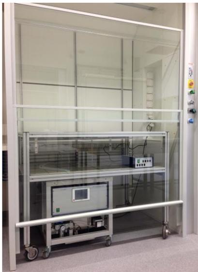
Das Installationsbeispiel zeigt den Aufbau des Puffersystems mit der Systemplattform und dem PSM-420 Sicherheitsschaltmodul von HPLConsult in einer Stehkapsel.
